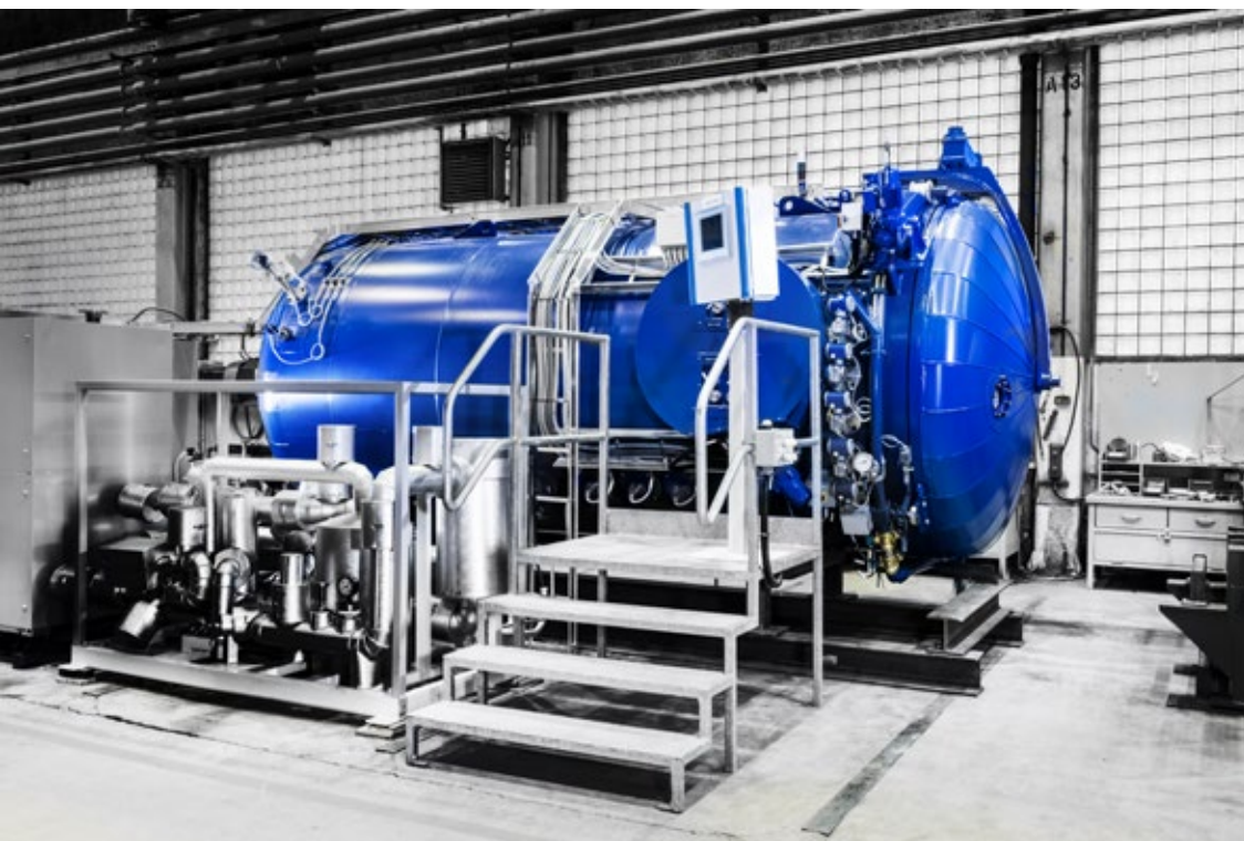
Platom Oy:n autoklaavi uraaniheksafluoridin UF 6 käsittelyyn (Platom).
